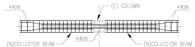
TYPICAL COLLECTOR REINFORCEMENT
